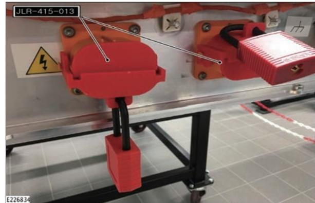
セーフティーロックが入手できない場合は、図のような樹脂製の絶縁キャップを取り付ける。もしくは、絶縁テープを使用して高電圧コネクタが露出しないようにして安全を確保する必要がある。
